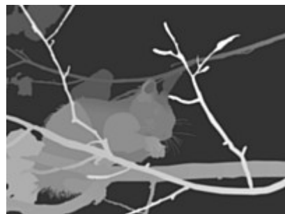
- Croc-croc 3D (depthmap) ©AbsurdePhoton - Le depthmap de l'écureuil pour construire l'image gauche et droite en 3D
